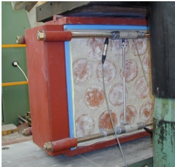
Abbildung 5 Versuche mit zentrischer Belastung mit Querdehnungsbehinderung
