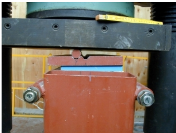
Abbildung 5 Versuche mit zentrischer Belastung mit Querdehnungsbehinderung
